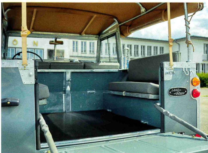
Freisitz: Sämtliche Polster wurden vom Autosattler auf den Original-Gestellen neu aufgebaut.
